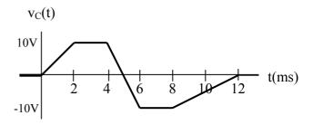
**III.2** La onda de tensión de la figura es del tipo utilizado para controlar el barrido horizontal de una TV. Dibujar la onda de corriente si tal tensión se aplica sobre un condensador de 2.2 nF.
