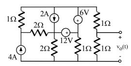
**II.7** Calcular la tensión de salida  $v_o(t)$  aplicando el procedimiento de análisis por mallas
