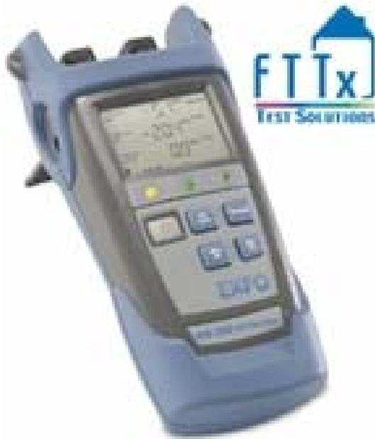
Capacidad **pass-through**: puede conectarse entre el OLT y la ONT y no interferir con el tráfico (voz, datos, video) en vivo en el enlace. El medidor extrae una pequeña cantidad de la señal para hacer la medida.
